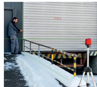
Funzione a impulsi: il ricevitore manuale consente di impiegare CROSSLINE anche in esterni per distanze fino a 80 m, rendendolo il laser a linee incrociate dalla portata in assoluto più ampia nel suo genere.
